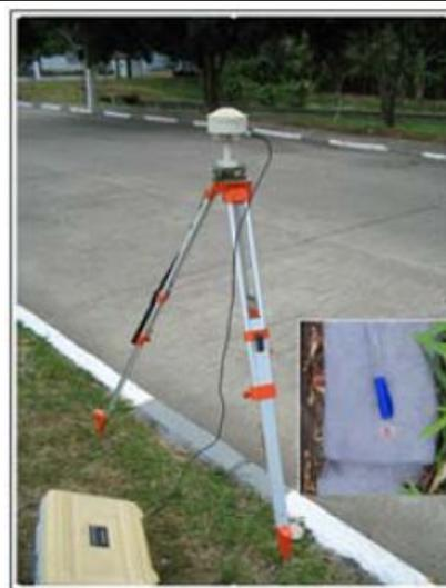
Vértice P1 ocupado com tripé e receptor GPS.
