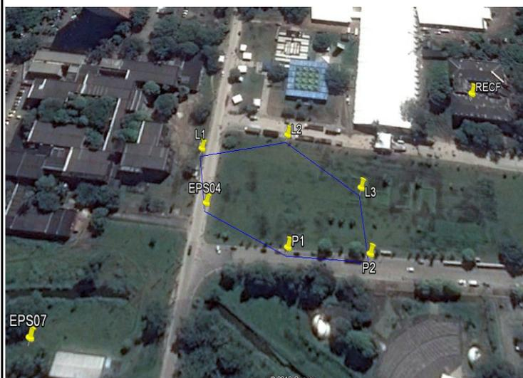
O vértice P1 situa-se no canteiro central da Av. dos Reitores, em frente a concha acústica da UFPE, cravado no bloco do paralelepípedo de granito do canteiro central.
