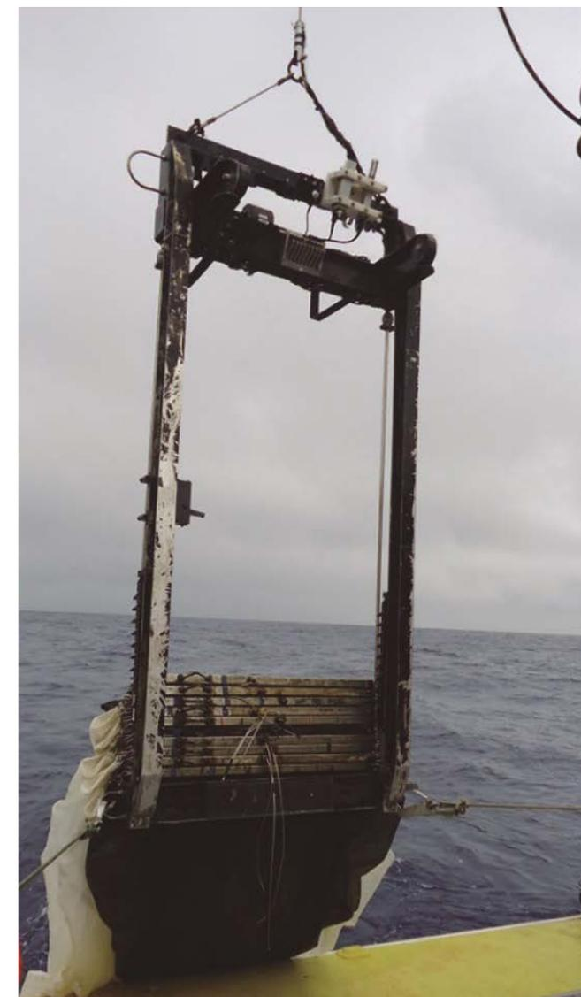
Figura 2.6 – Rede MOCNESS utilizada para amostragem de zoo e ictioplâncton em múltiplas profundidades. Na parte superior da rede há um CTD SBE acoplado para medição de temperatura, salinidade e profundidade. Fonte: PETROBRAS/UFPE - Projeto Marseal.
