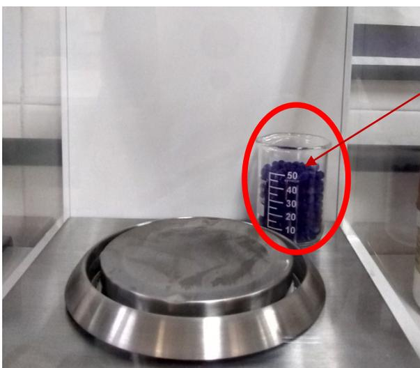
A balança sempre deverá conter um recipiente com sílica em gel para retirada da umidade deste ambiente.
