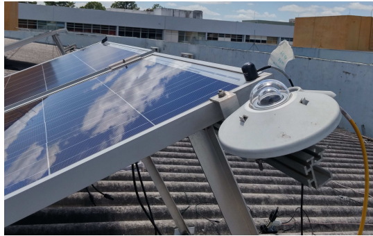
Figura 35 – Extrutura da montagem experimental. Módulo GBR 255p e Piranômetro CMP11 .
