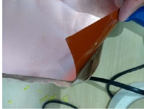
Figura 5.2 - Poliamida usada para a fabricação da antena, na foto destaca-se a sua flexibilidade, a parte laranja é a poliamida, a parte mais brilhante, o laminado de cobre.
