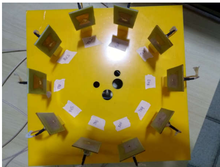
Figura 6.7 – Tomógrafo com as antenas apostas e prontas para medição
