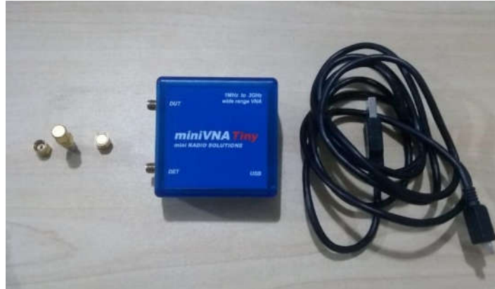
Figura 5.3 - MiniVNA tiny da MRS, foto ilustrando o analisador de rede usado e seus componentes.
