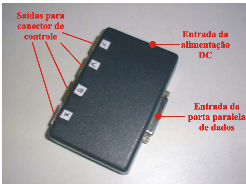
Fig.3.14 Foto da interface eletrônica usada no reflectômetro.
