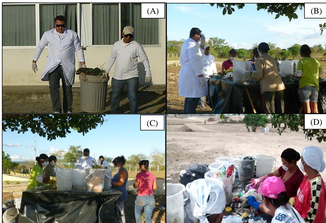
Figura 24: aferição da massa das amostras (A) orientação quanto a segregação dos resíduos (B) segregação em baldes de 20 litros (C) segregação dos resíduos por categorias (D).
