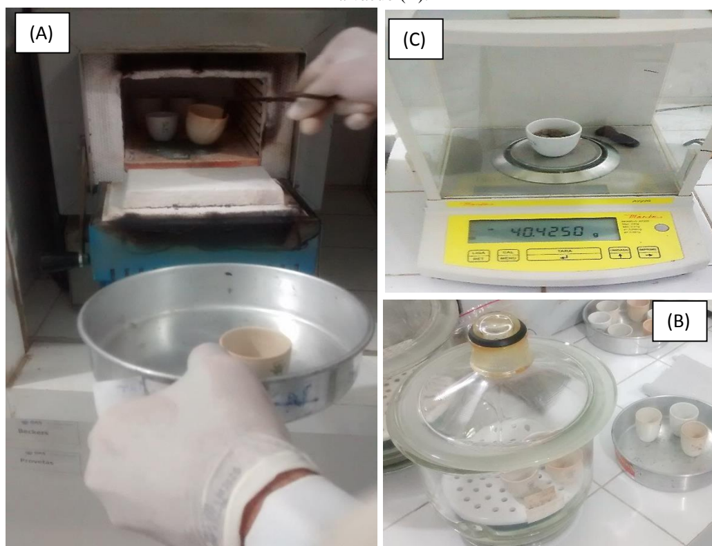
Figura 28: mufla utilizada para ensaio de sólidos voláteis (A); aferição da massa pós calcinação (C); dessecador a vácuo (B).
