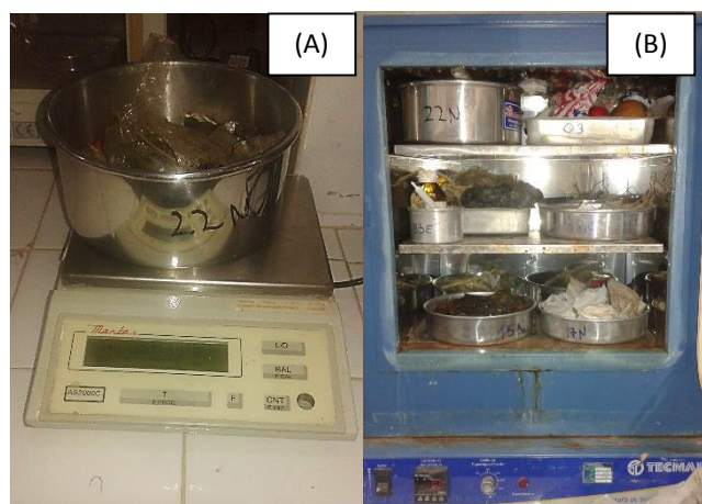
Figura 26: aferição da massa dos resíduos (A). Resíduos dispostos na estufa a 65°C (B).
