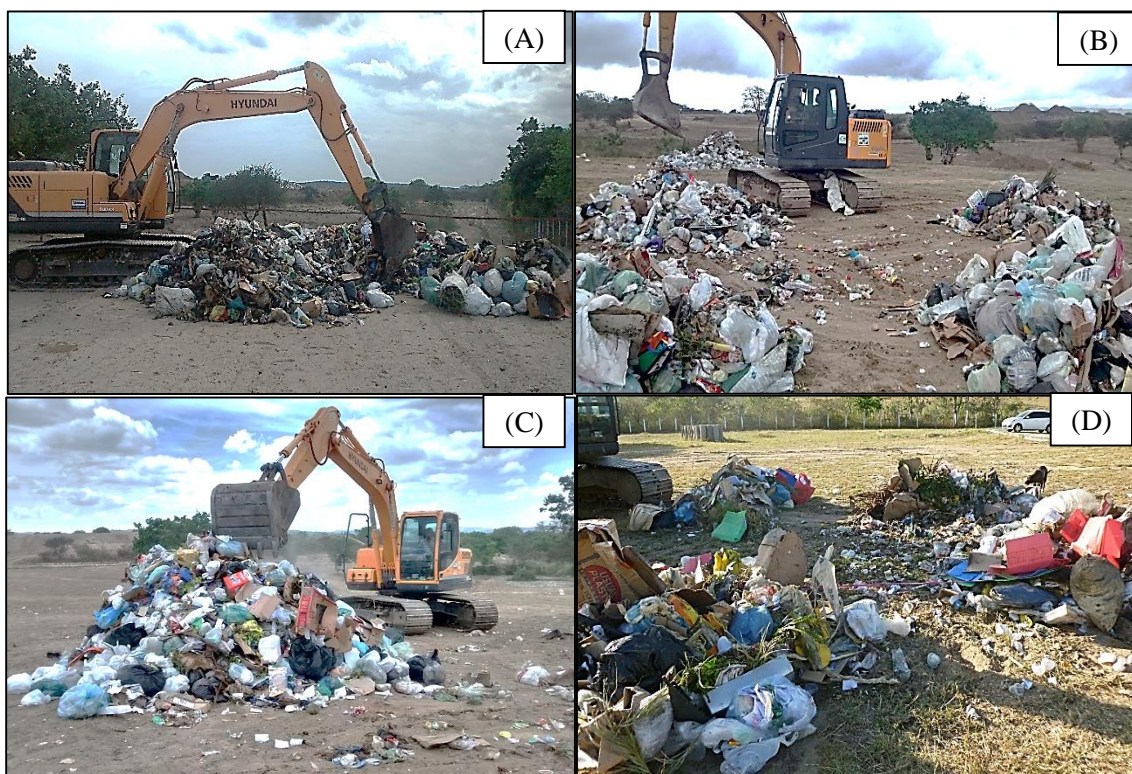
Figura 22: homogeneização dos resíduos (A) quarteamento dos resíduos (B) segunda homogeneização dos resíduos (C) novo quarteamento dos resíduos e seleção de duas amostras (D).
