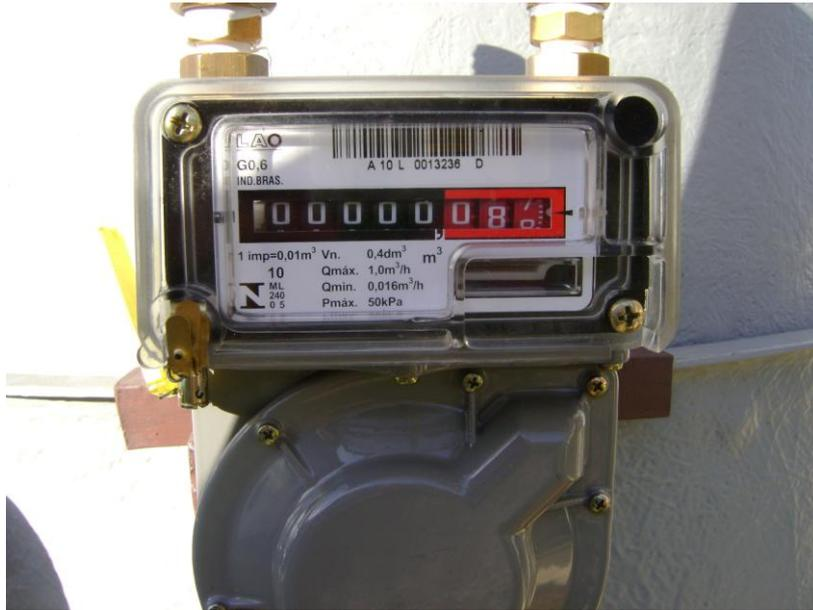
**Figura 11. Medidor de Gases usado no experimento. Fonte: O autor, 2011.**
