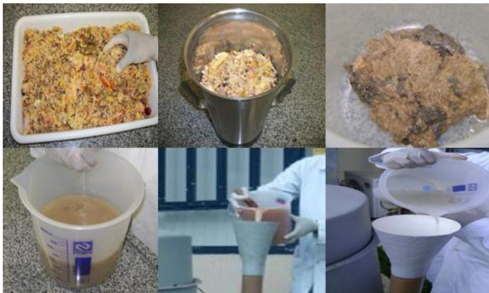
**Figura 9. Preparação do afluente e alimentação do biodigestor. Fonte: O autor, 2011.**
