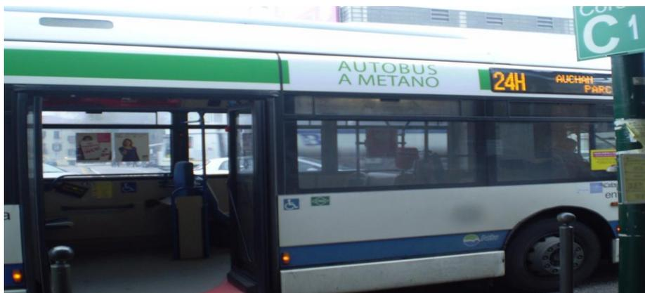
**Figura 3. Ônibus movido a metano gerado pelo processo anaeróbico na Itália. Fonte: Arquivo Pessoal de Simone Machado Santos, 2010.**
