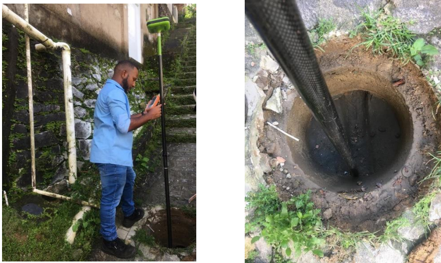
Figura 40 e 41: Coleta da profundidade da Caixa com o Rover
