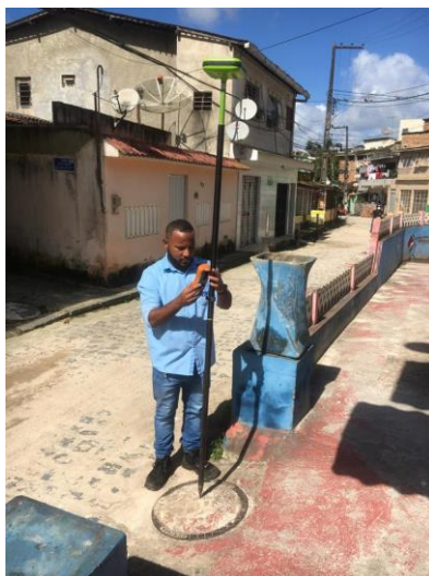
Figura 42: Coleta da cota de Tampa do Poço de Visita
