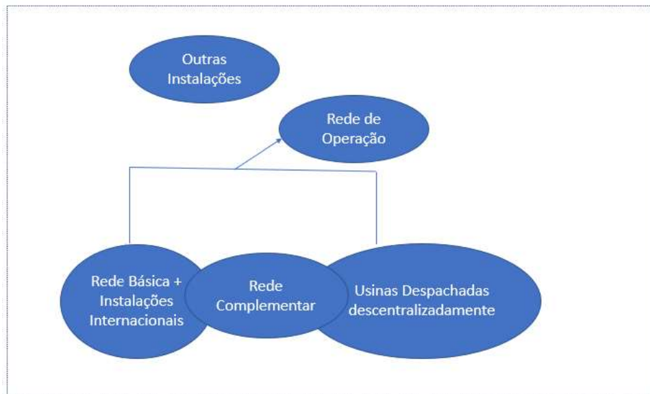
Figura 1 - Rede de operação do sistema elétrico brasileiro
